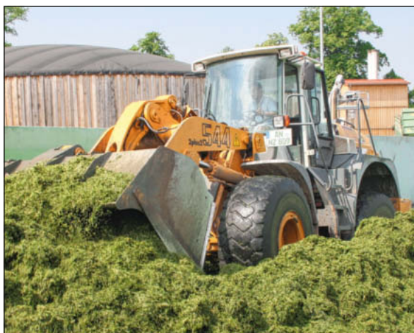
Radlader sind vielfach als Walzfahrzeuge im Einsatz.
