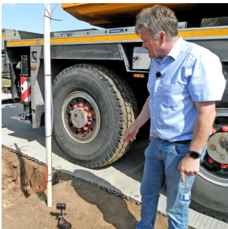
Durch die Alu-Matten kann der Bodendruck enorm reduziert werden, wie Norbert Bleisteiner beim Praxisversuch erläutert.
