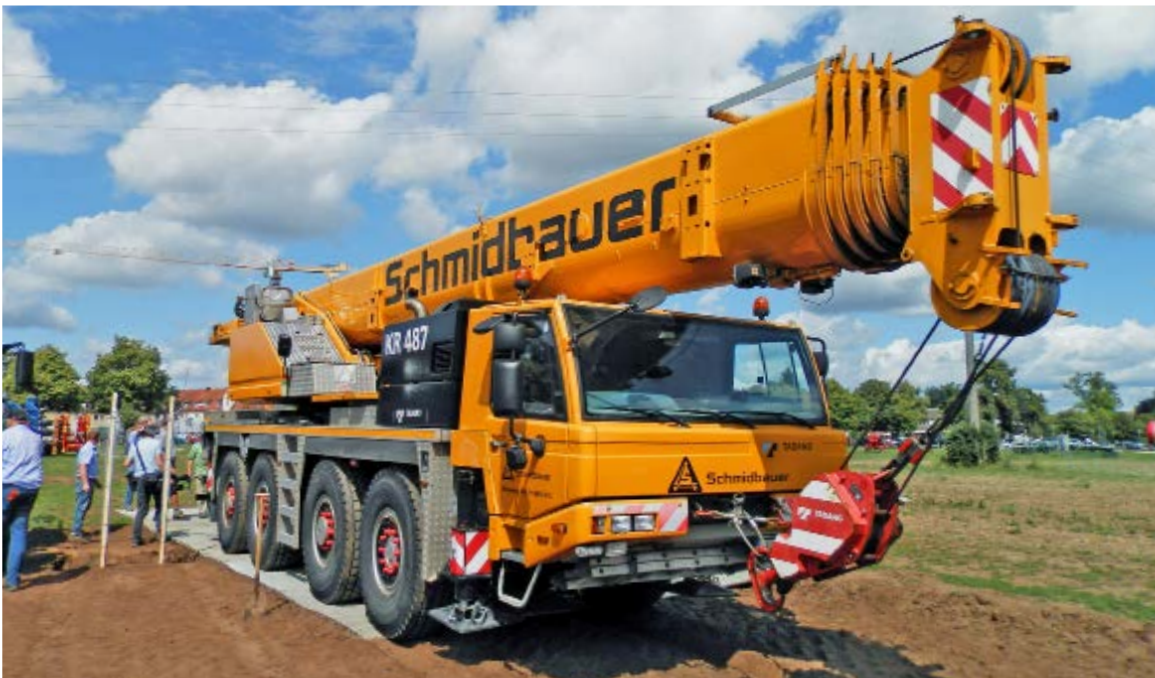
Eindrucksvolle Technik wurde beim Medientag aufgefahren, wie dieser 100 t-Kran mit vier Achsen zum Bau von Strommasten.
