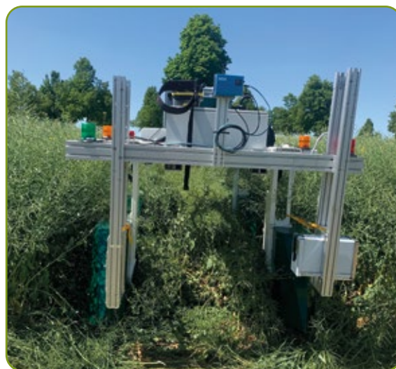
Mobiles Röntgengerät des Fraunhofer Instituts beim Einsatz im Triesdorfer Raps
