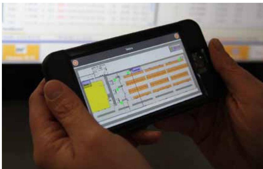
Mit sogenannten Kuh-Navis lassen sich Tiere im Stall einfach finden. Auf dem Smartphone oder PC wird die Position der Tiere dargestellt. Foto: Reimink
