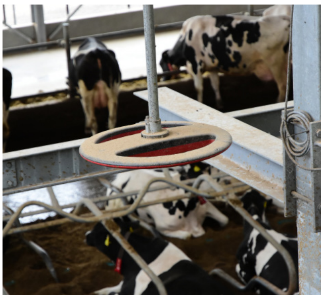
Antennen im Stall ermitteln die Daten der Sensoren und leiten diese weiter an den PC oder direkt ins Internet.
