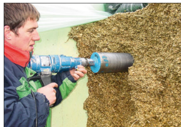
Mit den Kernbohrungen wurde der Dichtegrad im Silo an verschiedenen Stellen gemessen.
