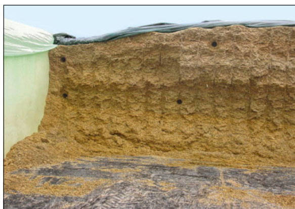
Mit den Kernbohrungen wurde der Dichtegrad im Silo an verschiedenen Stellen gemessen.
